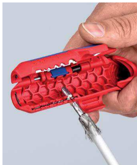
Abisolieren eines Koax-Kabels
