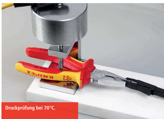
Prüfung der Haftfähigkeit der VDE-Hüllen mit 500 N.
