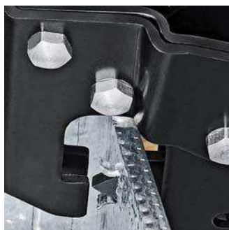
Das Stempelwerkzeug wird durch die Profilbleche gedrückt
