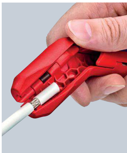
Abmanteln eines Koax-Kabels
