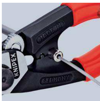
Anpressen der Endhülse an die Bowdenhülle
