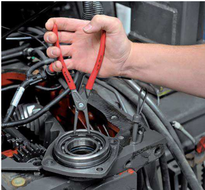
Stabile, eingesetzte Spitzen aus hochverdichtetem Federstahl
