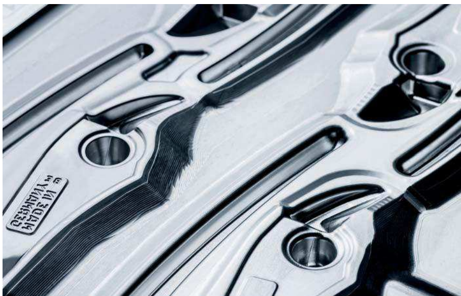
Schmiedegesenk für den Kraft-Seitenschneider mit angeschmiedeter Gelenkachse.
