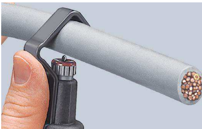
Ansetzen des Werkzeugs für Umfangsschnitt
