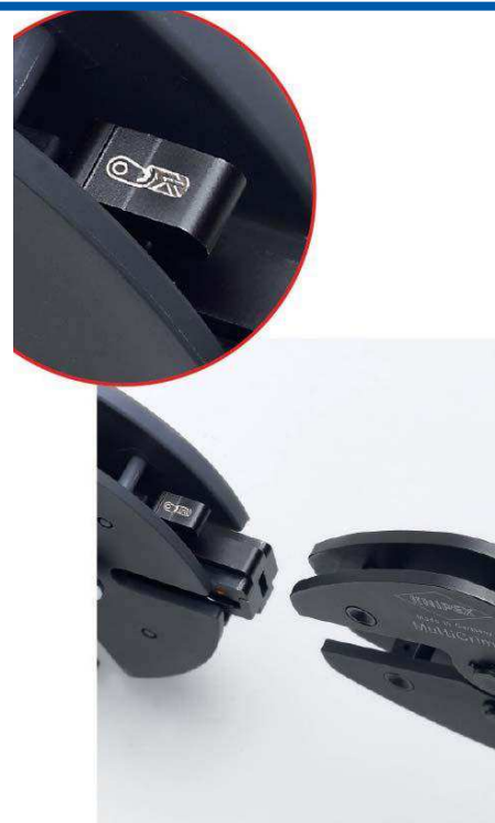
Gut sichtbare Kennzeichnung der Crimpeinsätze mit Piktogrammen
