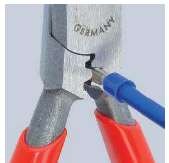
Crimpen 0,5 bis 2,5 mm 2
