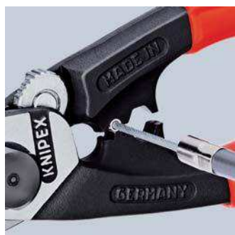
Anpressen der Endkappe an das Zugseil
