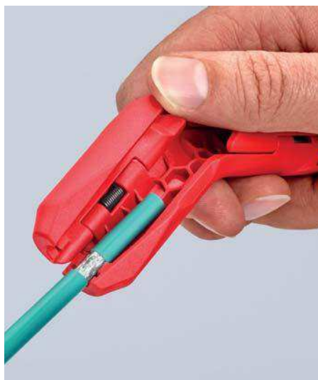
Abmanteln eines Datenkabels
