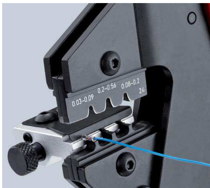
97 43 200 mit Crimpeinsatz 97 49 24 und Positionierhilfe 97 49 93 für D-Sub-Stecker
