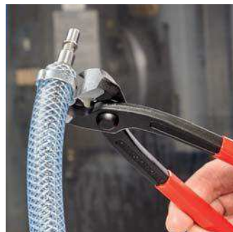
Abdichten Pneumatikschlauch an Schnell- kupplung mittels der Front-Pressnase
