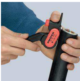
Ansetzen des Werkzeugs für Längsschnitt
