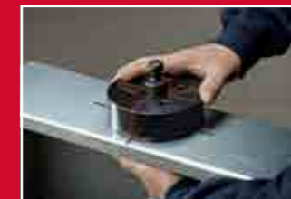
SET UP - výrazné krížiky a jasný pohľad na pracovnú plochu umožňujú rýchle a jednoduché vyrovnanie
